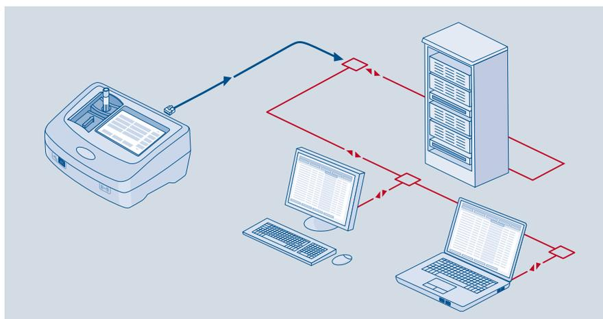
Los datos de medida del espectrofotómetro DR 3900 se transmiten mediante conexión Ethernet o bien mediante USB. No se requiere de un software especial.
