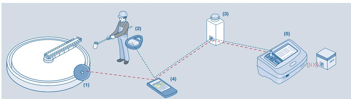
El localizador RFID LOC 100 (4) transmite los datos relativos a la localización de la muestra (1) y a los tags RFID de usuario (2) y RFID de la muestra (3). La tecnología RFID utiliza tags [pestañas] como emisores de datos. El espectrofotómetro DR 3900 (5) lee automáticamente los datos de muestreo desde el tag RFID de la muestra (3). Esto es: la localización de la muestra, quién ha tomado la muestra, la fecha, la hora, etc.
