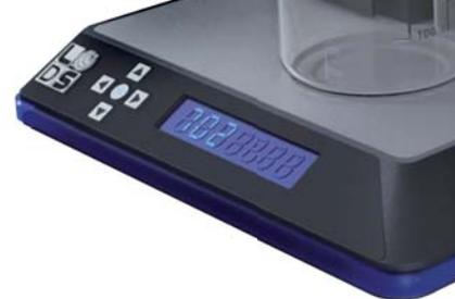
Este aparato fue concebido para medir rápidamente y sencillamente el SO<sub>2</sub> libre y total, suprimiendo la apreciación delicada del final de la dosificación. El Iodolyser es particularmente adaptado a los vinos, aún con mucho color, los sedimentos para destilación, los zumos de fruta, las bebidas alcohólicas y los vinagres.
