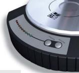
Este aparato fue concebido para medir rapidamente y sencillamente el SO<sub>2</sub> libre y total, suprimiendo la apreciación delicada del final de la dosificación. El Sulfilyser es particularmente adaptado a los vinos tintos con mucho color, los sedimentos para destilación, los zumos de fruta, las bebidas alcohólicas y los vinagres.
