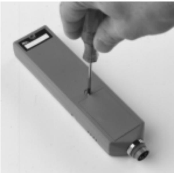
Para sustituir la pila desenroscar el tornillo con cabeza en cruz de la tapa del alojamiento de la pila,
