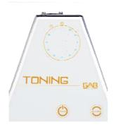
Todos los leds azules encendidos: Final de análisis. Permanecerá así hasta que se pulse otra vez run/stop. Leer volumen de la bureta gastado y multiplicar por el factor correspondiente según tabla.
