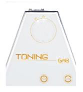
Led #1 y Led #2, blancos, parpadeando: Ajuste no OK. Repetir análisis con 10 mL de muestra.
